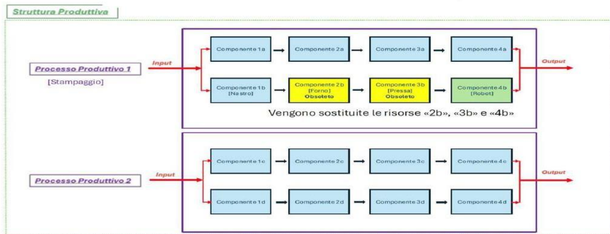
Figura 4.24.2: Schema della struttura produttiva con evidenziata la linea b) del Processo Produttivo 1 e i componenti 2b, 3b e 4b da sostituire.
